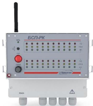
Предназначен для приема по радиоканалу информации от сигнализатора горючих газов СГГ10-Б-ПК, передачи этой информации по каналу GSM и выдачи дублирующей световой и звуковой сигнализации, соответствующей состоянию сигнализаторов.
